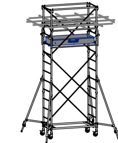
**8** Rehausser le plancher à 1m de la lisse supérieure. L'échafaudage est conforme pour travailler au-dessus du faux plafond.
