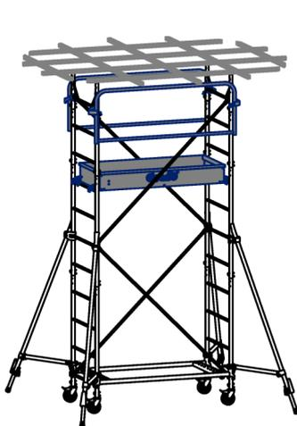
**4** Rehausser le plancher et les garde-corps au maximum.
