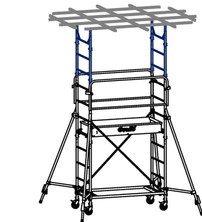
**2** Ajouter les *échelles SFP 1 et 2 barreaux* si nécessaire. Régler également les roues si nécessaire. Goupiller ces échelles.
