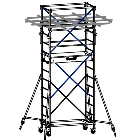
**7** Contreventer les 2 lisses supérieures à l'aide de 2 diagonales. Repositionner si nécessaire les diagonales inférieures.
